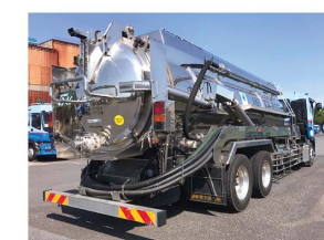
10t汚泥廃液吸引車
